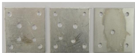
b 螺接试样外观形貌
