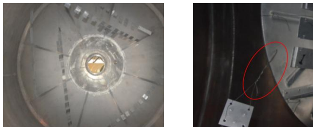
图2 箱内液压浸泡试样悬挂安装情况
