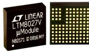
图 1 LGA 器件结构图
